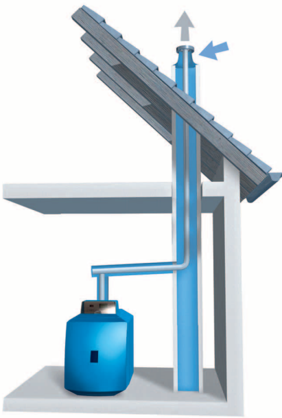
Λειτουργία ανεξάρτητη από τον αέρα του χώρου εγκατάστασης με αγωγό καπναερίων σε υπάρχουσα καπνοδόχο
